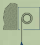
Caixa de enrolamento na parede, cortina corre na frente
